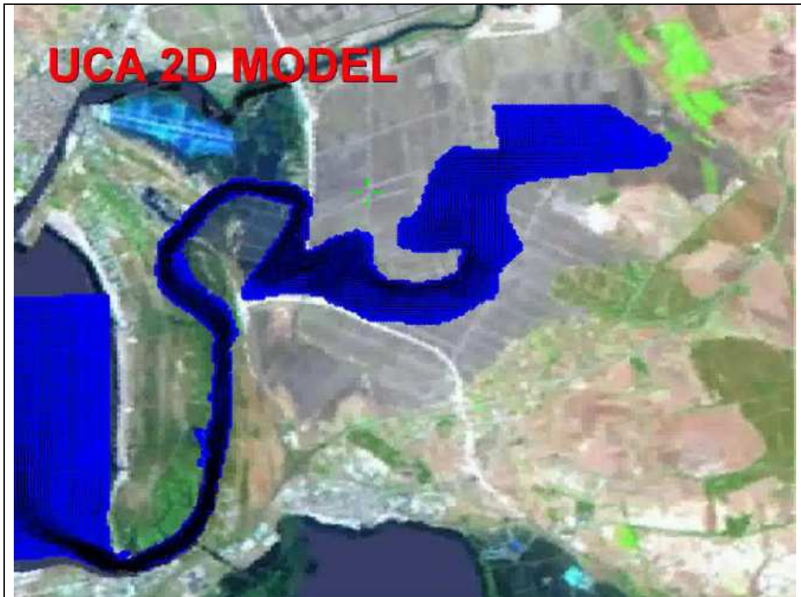
Figura 26. Representación de la zona intermareal anegada en condiciones de marea viva equinoccial al eliminar la presa. (Imagen más detallada de la figura 5)
