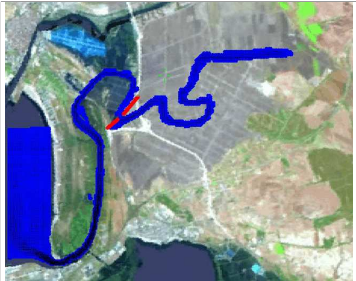
Figura 25. Escenario representativo de la fracción de talud (en rojo) eliminada para facilitar el tránsito de agua a través de la presa. (Imagen más detallada de la figura 5)
